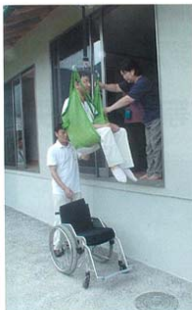
南のはき出しの外へ用意した車いすへ、スリングを掛けて降りる（上下移動は電動で行う）リフトは持ち出しがで、200キロまで耐えられるメーカーを選んだ
